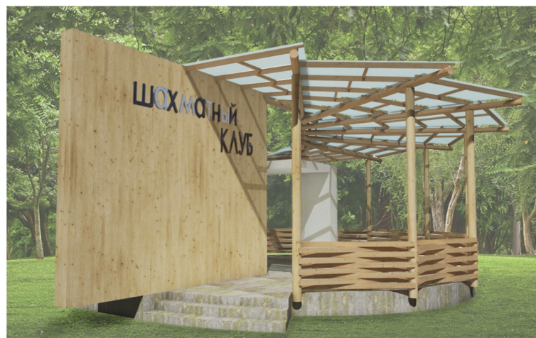
Материалы, применяемые при ремонте павильона: Доска сосновая, монолитный поликарбонат, покрытие защитной пропиткой для дерева.
